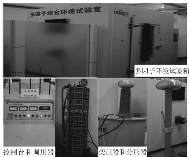
图1 环境试验箱及加压装置
